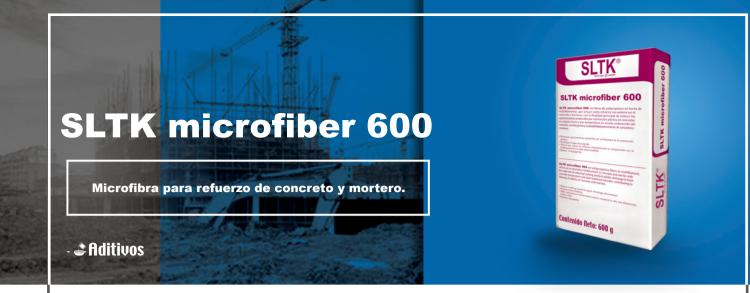
SLTK microfiber 600 son fibras de polipropileno en forma de multifilamentos, que actúan como refuerzo secundario en el concreto y morteros, con la finalidad principal de reducir los agrietamientos producidos por contracción plástica en concretos en estado fresco y por temperatura en estado endurecido del concreto, contribuyendo a la durabilidad permanente de concretos y morteros.
