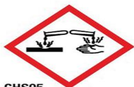
GHS05 Sustancias corrosivas (CR)
